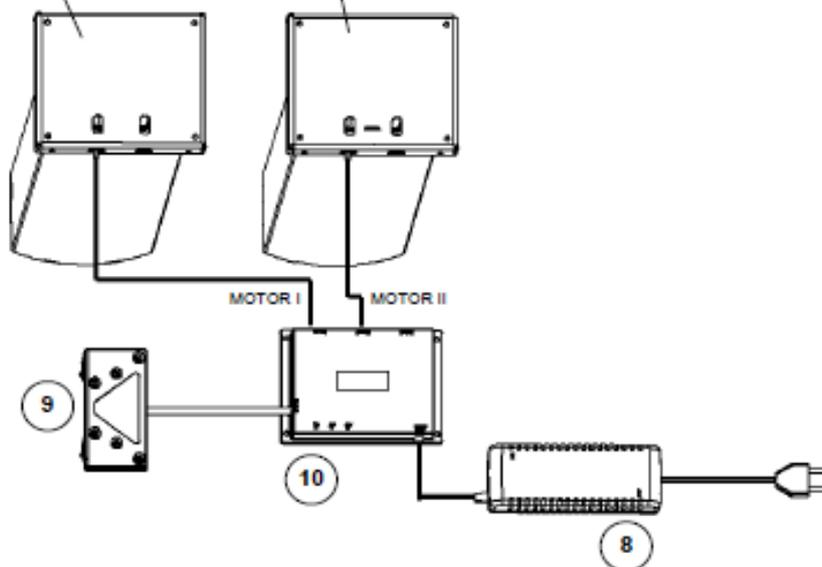
**ANMERKUNG: Verbinden Sie alle Stecker miteinander bevor Sie das Gerät an die Hauptstromquelle angeschlossen wird.**
